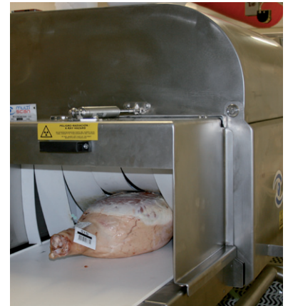
Figura 5: Inspector de rayos X (X20V G90, Multiscan Technologies, SL, Cocentaina, España) utilizado para la determinación del contenido de sal
