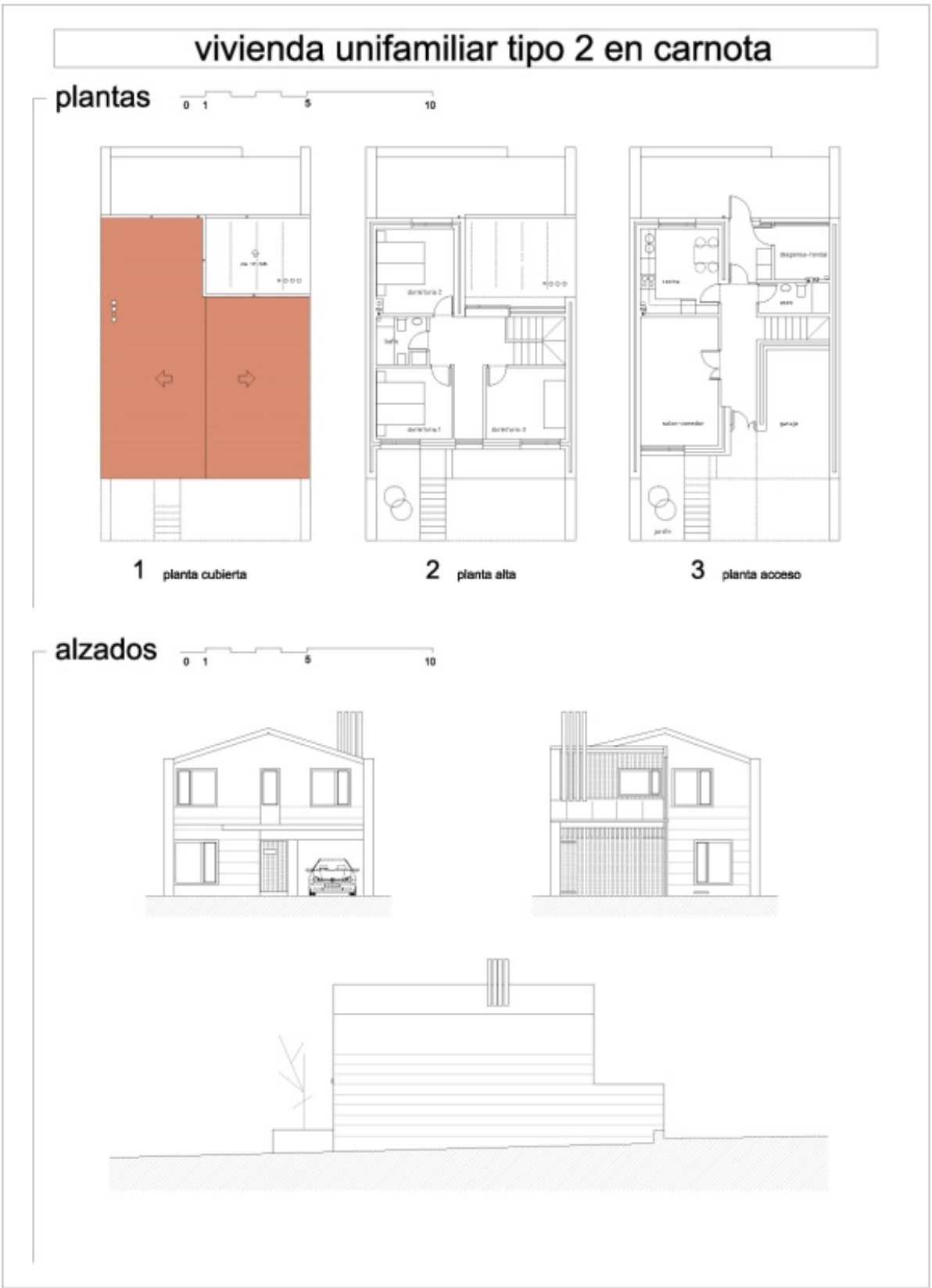
Figura 26. Vivienda unifamiliar Tipo 2 en Carnota
