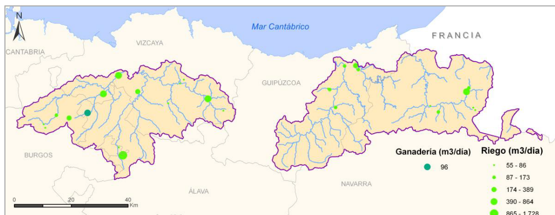
Figura 15. Extracciones superficiales para agricultura (riego) y ganadería con un volumen superior a 20.000 m 3 /año
