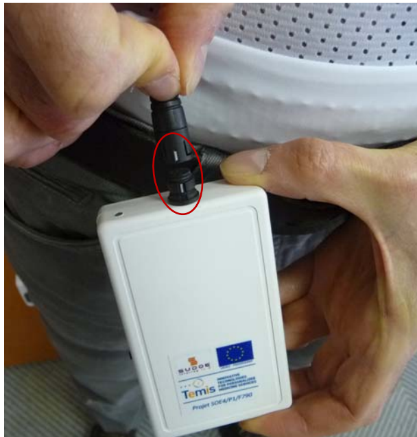
Figure 9: Connecter le boîtier au T-shirt en alignant les marques blanches
