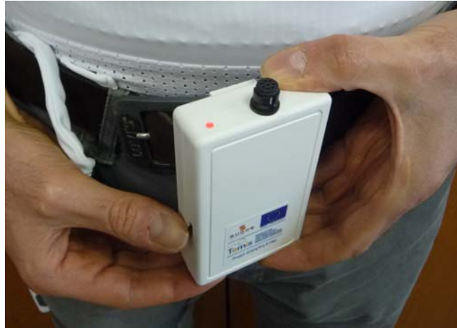
Figure 8: Prendre le boîtier, l'allumer et attendre que la diode du boîtier passe au vert
