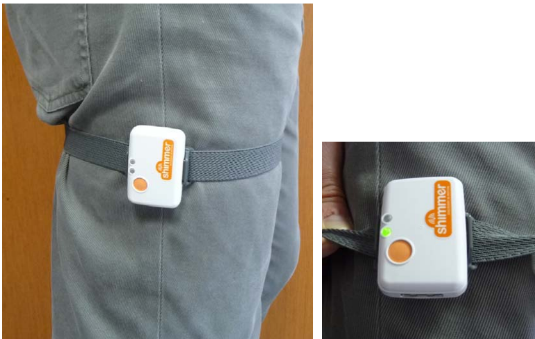
Figure 4: Module positionné avec le rond orange et le connecteur situés vers le bas
