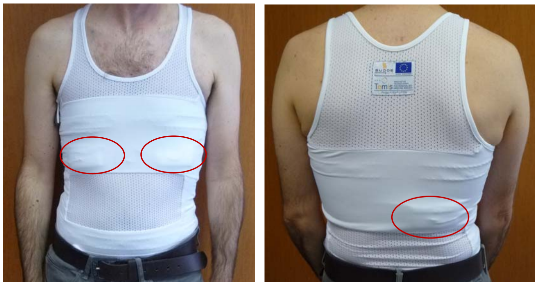
Figure 7: Position des capteurs permettant de mesurer la fréquence cardiaque
