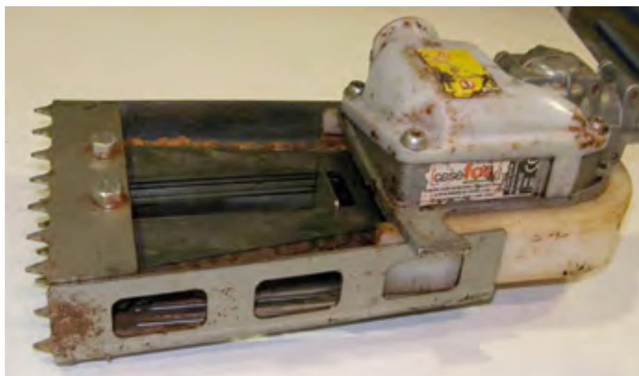
Figura 9. Herramienta de resinar HR2.
