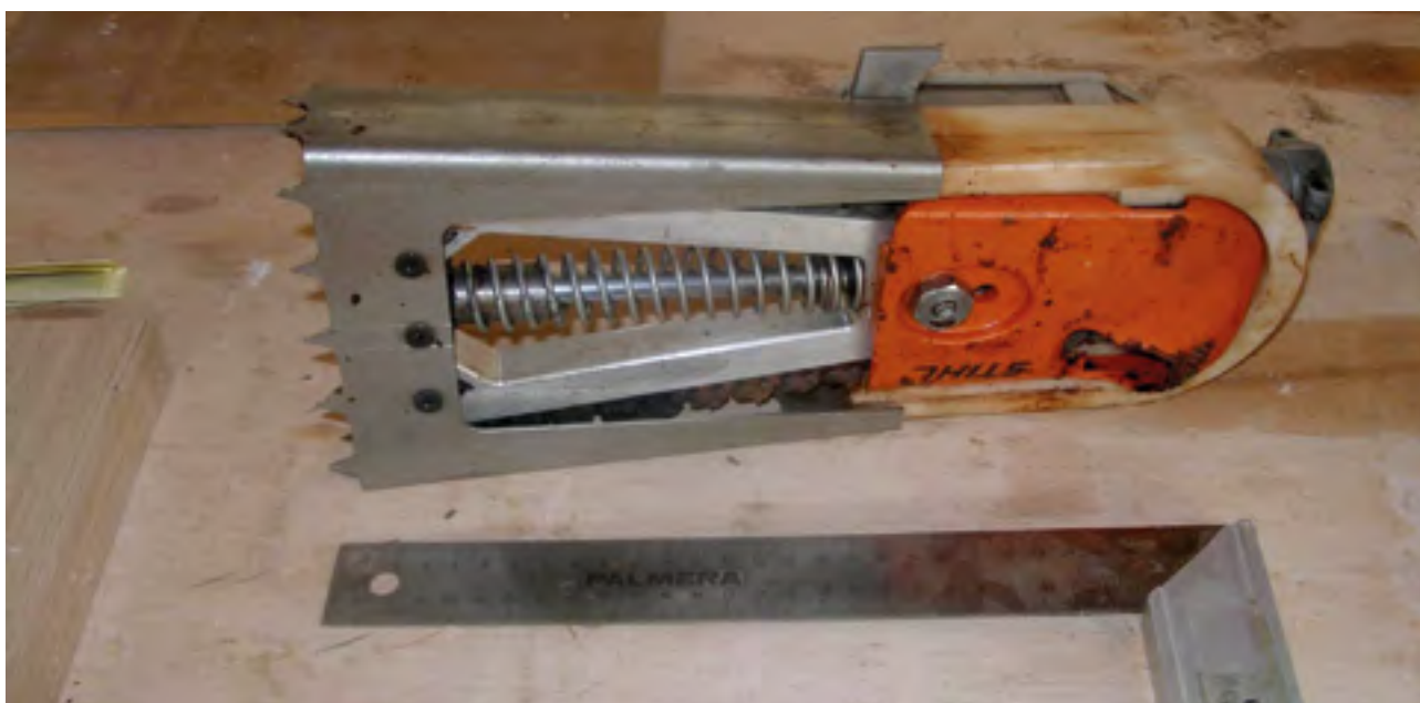
Figura 5. Herramienta de resinar HR1.
