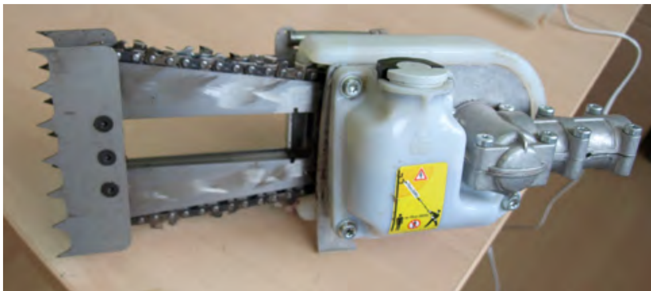
Figura 7. Herramienta de resinar HR2.
